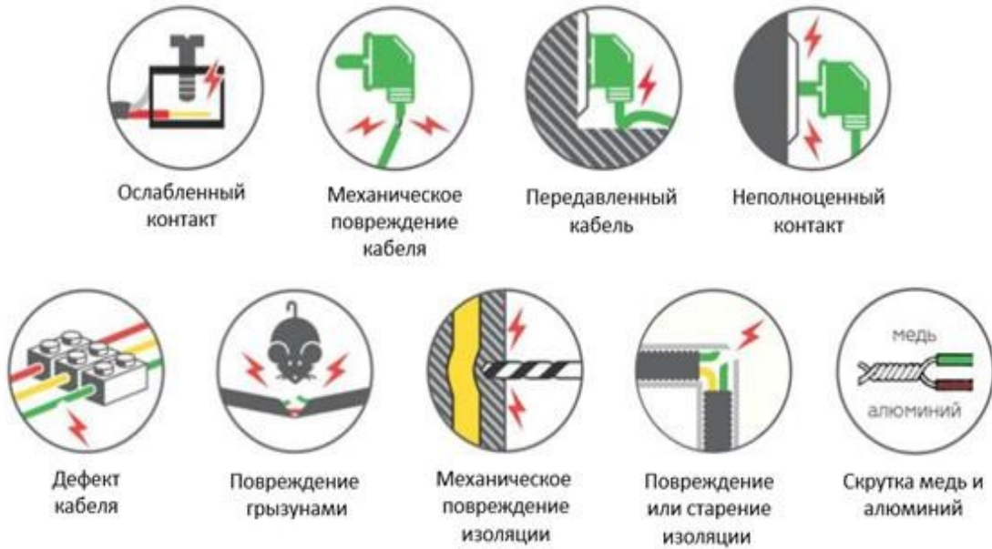
Рисунок 6. Возможные причины искрения в электропроводке
